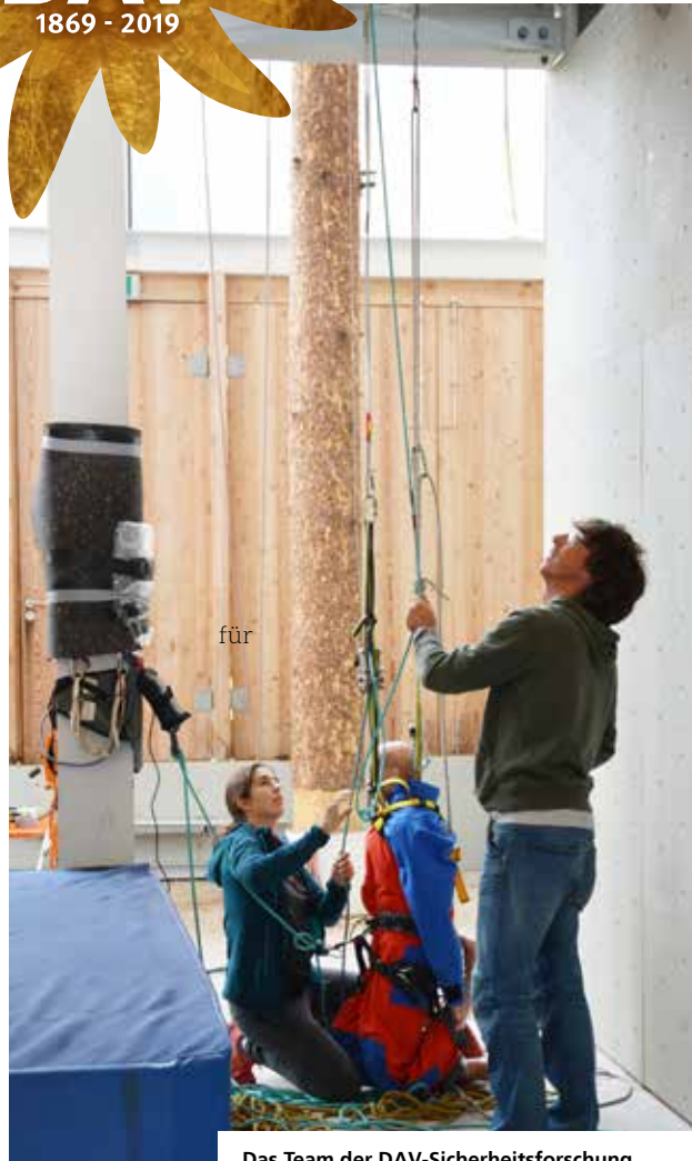
Das Team der DAV-Sicherheitsforschung beim Testaufbau für den Nachweis der Haltekraft beim Sichern mit Tube über den Körper. Die Sicherheitsforscher des Deutschen Alpenvereins nutzen regelmäßig die statischen und dynamischen Prüfvorrichtungen des BW-ZSA. Die Testergebnisse und die Interpretation der Werte werden in der Mitgliederzeitschrift des DAV „Panorama“ veröffentlicht.
