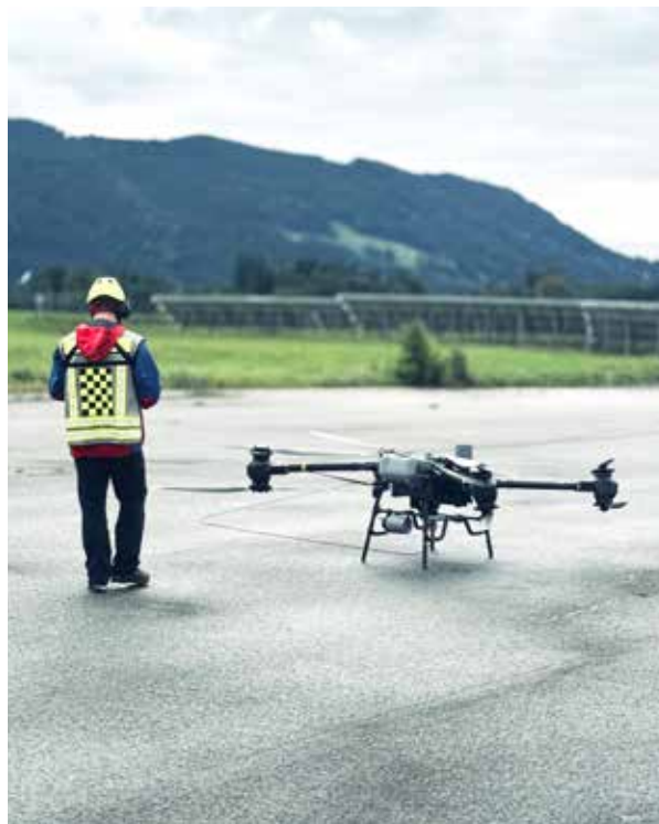
DJI FlyCart 30. ca. 3 m Durchmesser im ausgeklappten Zustand
